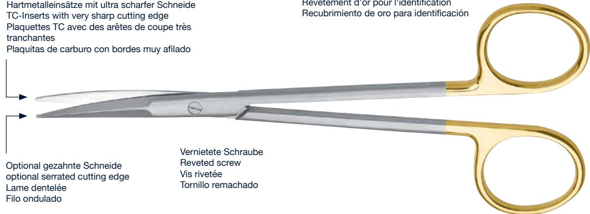
**S**eit 1961 produzieren wir Scheren mit Hartmetall-Einsätzen. Diese sogenannten TC-Einsätze werden in einem speziellen Sinterverfahren hergestellt und garantieren durch die hohe Härte eine hervorragende Performance und Langlebigkeit der Schere. Die TC-Einsätze werden in einem aufwendigen Verfahren während dem Härtprozess im Vakuumofen mit dem Grundmaterial verbunden und im Anschluss auf modernsten CNC Maschinen geschliffen. Erfahrene Chirurgiemechaniker übernehmen das Fertigmachen der Schere.
